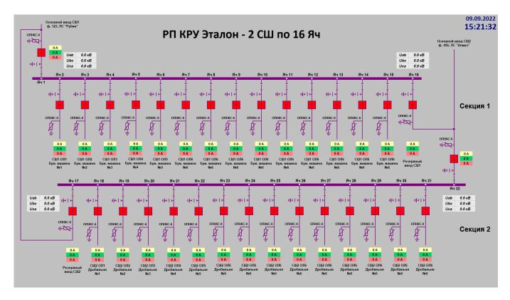
Сервер SCADA-системы ЭНТЕК обеспечивает сбор данных и управление оборудованием КРУ Etalon. Связь с верхним уровнем осуществляется с использованием контроллера КМ ЭНТЕК E2R2 (G) по интерфейсам RS-232/485 и Ethernet.
