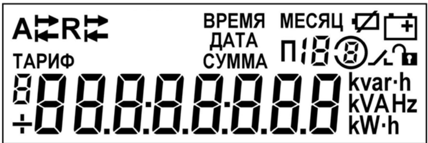
Рисунок 10 - Общий вид ЖКИ блока индикации счетчика наружной установки в корпусе SPLIT
